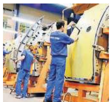
Latécoère réalise les portes des Airbus A320 et Boeing 787. / DR
